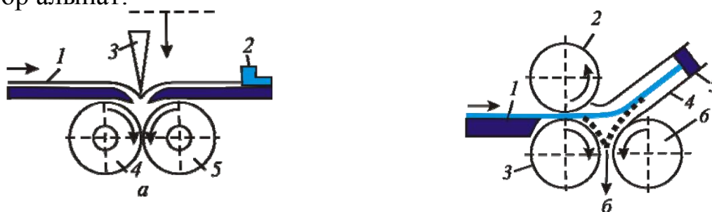
57-сүрөт. Ар кандай фальцовкалоочу түзүлүштөрдө бүгүштү түзүү схемасы: a – бычак менен фальцовкалоо принциби; б – кассеталык фальцовкалоо принциби
